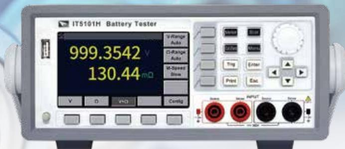
IT5100系列内阻测试仪是一款高精度、高分辨率、高速的电池内阻测试仪。采用交流四端子的测试方法，可更精准地测试电池内阻和电压。电阻分辨率可达 $0.1\mu\Omega$ ，电压分辨率可达 $10\mu\text{V}$ 。利用外部U盘存储，可长时间进行统计运算。内建比较器功能，可自动判断电池参数是否符合标准，统计合格率，适合各种电池的检测和分拣。内建USB/LAN通讯接口，支持SCPI协议，适合锂电池、燃料电池、超级电容等测试，广泛应用于新能源汽车、电动产品、半导体、5G通信等行业，适合工业研发、来料检测、产线、计量院、系统集成、高校、研究所等各类场所。
