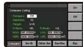
绝对比较允许用户设置电压和电阻的上下限，仪器根据测量值判断其是否在预设范围内，若不在预设范围内，则发出报警信号。
