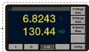
内阻+电压**同时高速测量和显示**
